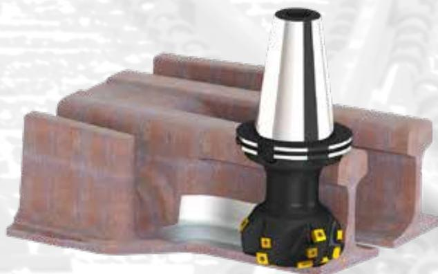
**Fresa speciale a mezzo profilo per lavorazione del gambo – due frese/due passate**
