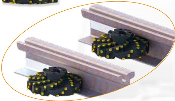
**Fresa a profilo speciale per la lavorazione del gambo rotaia in due passaggi**
