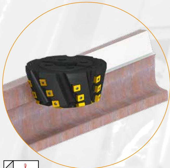
**Fresa conica per la lavorazione degli aghi**
