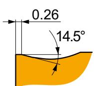
Diseñadas para mecanizado en semidesbaste y desbaste de fundiciones, potencialmente aceros y materiales duros, cortes continuos e interrumpidos.
