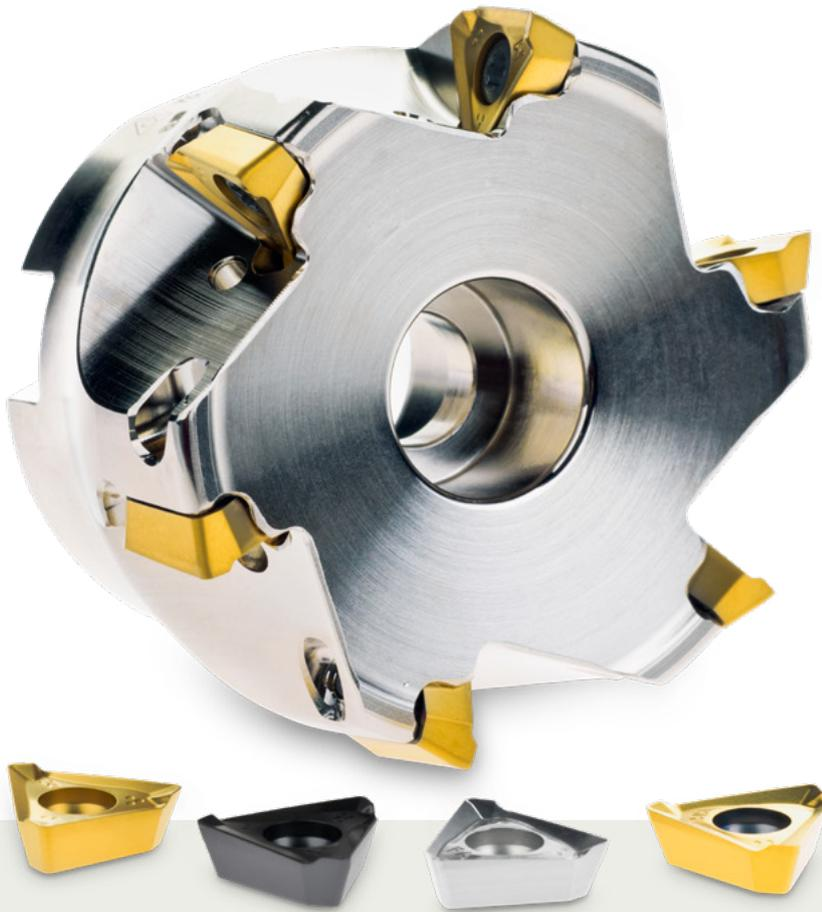
새로운 솔더 밀링 제품군으로 활용성과 비용 효율성을 높여보세요. STD 시리즈는 4개의 적응형 캐리어와 결합된 네 개의 삼각형 인서트가 특징입니다. 각 인서트는 3개의 절삭 날을 제공하여 공작물당 비용을 낮춥니다. 다양한 용도에 맞게 설계된 이 제품군에는 정삭, 중삭, 황삭 및 효율적인 알루미늄 가공을 위해 맞춤화된 4가지 특수 형상이 포함되어 있습니다.
