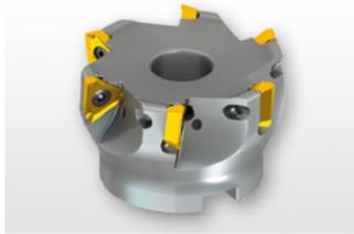
포지티브 설계 및 내부 절삭유를 갖춘 VER TD17 90° 사각 솔더밀 단면 TD.17 스타일 인서트와 11.0mm의 APMX를 활용한 다용도 90° 사각 솔더밀. 모든 공작물 소재의 광범위한 적용 분야에 적합합니다. 원통형, 웰던, 모듈형 및 아머 스타일, 디퍼런셜 피치 사용 가능. 공구 수명을 연장하기 위한 바디의 강화 처리.
