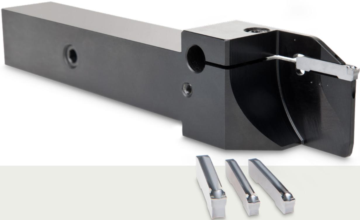
비철 소재 및 티타늄 기반 초합금의 깊은 절단 및 홈 가공을 위해 설계된 새로운 GL. S-PM 인sert를 소개합니다. 이 한 면 인서트는 큰 양의 경사각과 연마된 칩 브레이커가 특징이며, 연속 절삭에서 약 단속의 절삭까지 탁월한 칩 제어와 원활한 배출을 보장합니다.
