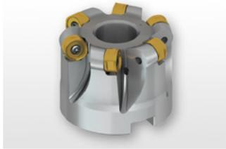
이중 네거티브 설계와 내부 냉각수가 있는 ECON RN10 복사기 APMX 4.5mm의 양면 네거티브 인서트 RNMU 10을 사용하는 경제적인 카피 밀입입니다. 페이스 밀링, 카피 밀링 및 고속 절삭에 적합합니다. 원통형, 모듈형 및 아버 스타일로 제공됩니다. 공구 수명을 연장하기 위해 바디를 처리했습니다.
