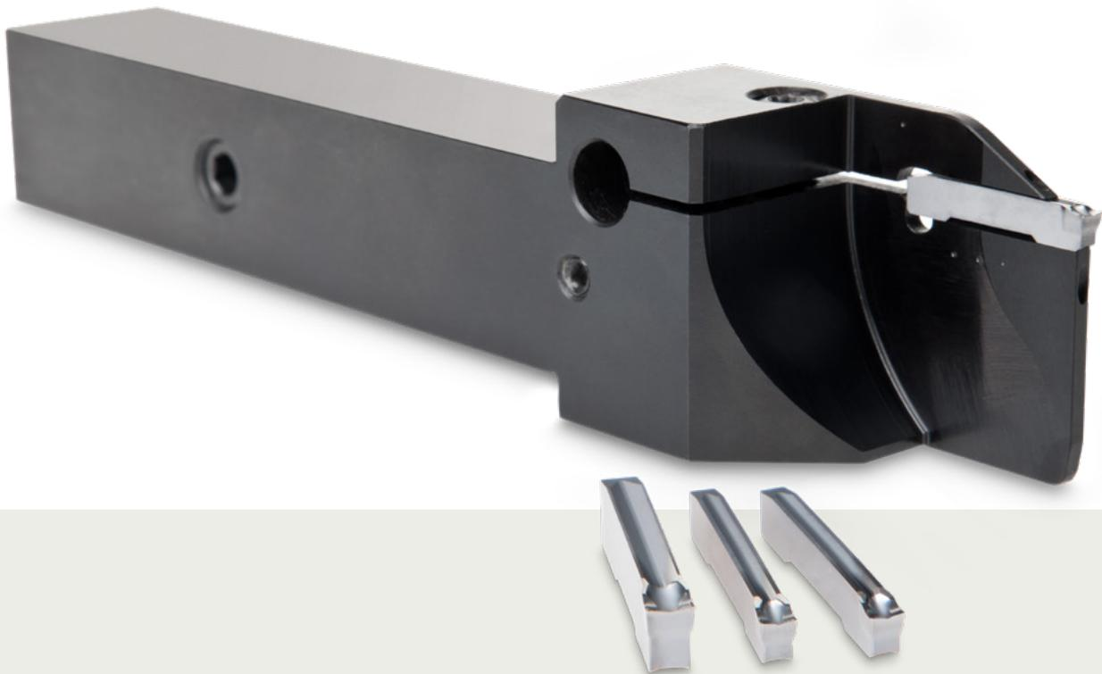
Wir stellen die neuen GL. S-PM-Wendeplatten vor - entwickelt für das tiefe Ein- und Abstechen von Nichteisenwerkstoffen und Superlegierungen auf Titanbasis. Diese einseitigen Wendeschneidplatten verfügen über einen äußerst positiven Spanwinkel und einer polierten Spanfläche, der eine hervorragende Spankontrolle und einen reibungslosen Abtransport bei kontinuierlichen bis leicht unterbrochenen Schnitten gewährleistet.
