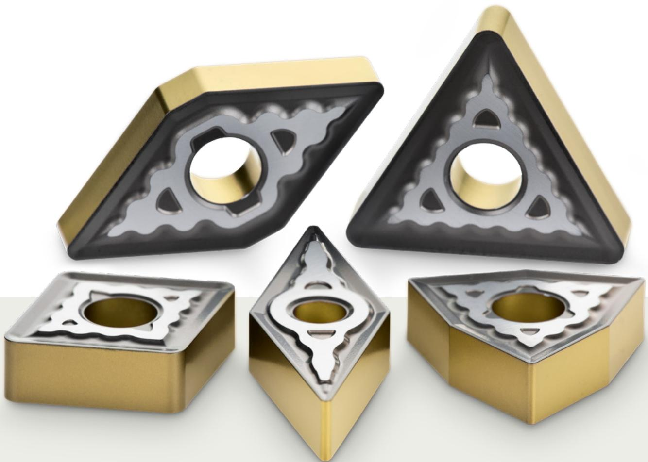
Der neue KM-Spanbrecher wurde speziell für Gusseisen (Werkstoffe der ISO K-Gruppe) entwickelt und ist die ideale Lösung für mittlere Drehanwendungen. Er zeichnet sich durch eine stabile, breite T-Fase und einen leicht positiven Spanwinkel für glatte, gleichmäßige Schnitte aus.
