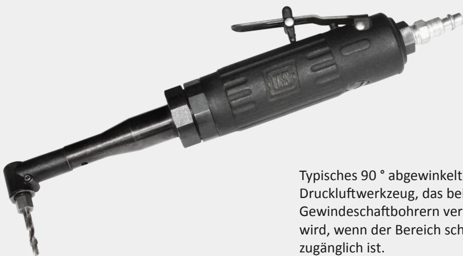
Typisches 90 ° abgewinkeltes Druckluftwerkzeug, das bei Gewindeschafthöckern verwendet wird, wenn der Bereich schwer zugänglich ist.
