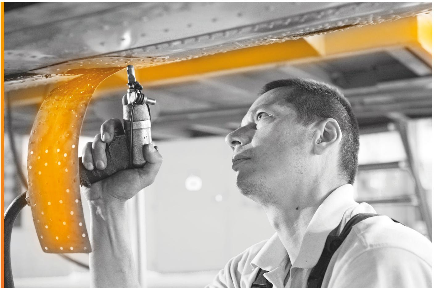
Unser Sortiment an Gewindeschafthöckern ist in drei Varianten erhältlich: HSS, HSS-E und Hartmetall. Diese sind zum Bohren von Materialien mit allgemeiner bis mittlerer Beanspruchung und geringer Zugfestigkeit auf engstem Raum. Die Hartmetallreihe kann verwendet werden zum Bohren von Verbundwerkstoffen. Eine nach NAS-Spezifikation hergestellte Spitzen-Geometrie reduziert die Schubkräfte und verbessert sie Positionsgenauigkeit beim handgeföhrten Bohren.
