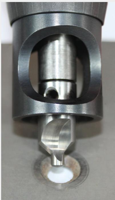
Micro-Stop-Vorrichtungen für geführte Senker helfen, einen senkrechten Anschnitt zu gewährleisten und ermöglichen einen genauen Durchmesser und Tiefe der Fase
